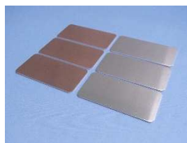
①将活性金属硬焊材料/铜 复合材料进行电路状冲压加工
